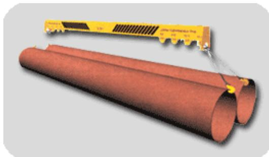
Предназначены для удержания при подъеме, перемещении и укладки в траншею изолированного трубопровода методом периодического перехвата, а также труб и секций длиной до 36 м при сварке трубопровода “в нитку”.
