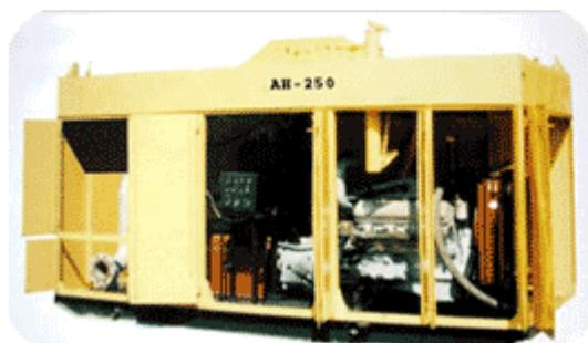
Предназначены в зависимости от комплектации для двух и четырехпостовой ручной дуговой сварки покрытыми электродами и полуавтоматической сварки неповоротных стыков стальных труб диаметром до 1420 мм, других сварочных работ, сушки и прокалики электродов, питания переменным электрическим током переносного электроинструмента при строительстве магистральных трубопроводов.
